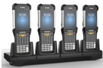
4-Slot Ethernet Cradle. Lädt vier Geräte parallel und verfügt über LAN Anschluß
